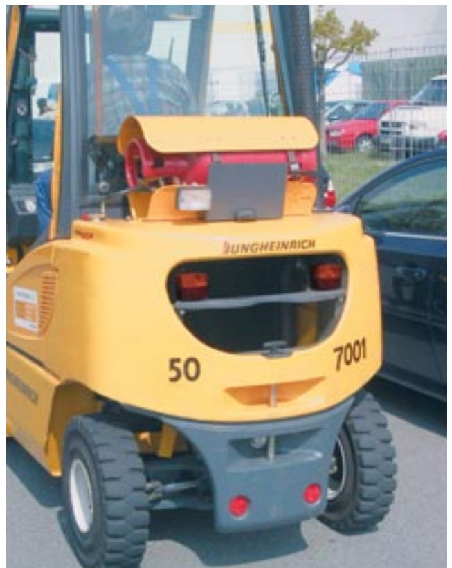
Bild 3: Schlussleuchten, Bremsleuchten, Rückstrahler und Fahrtrichtungsanzeiger
