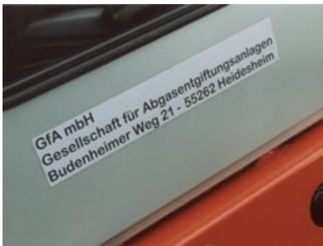
Bild 6: Beispiel für die Kennzeichnung eines Staplers
