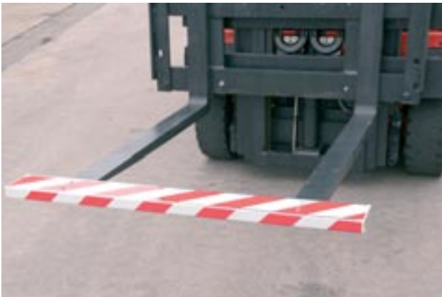
Bild 2: Schutzvorrichtung zum Abdecken der Gabelspitzen
